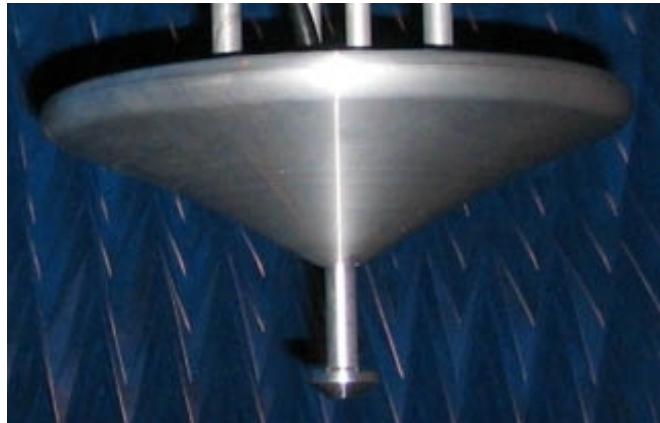
Figure 17 : Antenne en chambre anéchoïde
